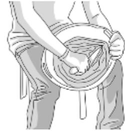
Mezcle el contenido de la bolsa en seco, para prevenir variaciones en el tono de la junta como consecuencia de la sedimentación de los pigmentos durante el transporte. No mezcle ALFAQUICK JUNTA FINA CG2AW con productos diferentes a los recomendados.
