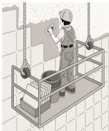
La cerámica como cualquier otro tipo de acabado no es un elemento estructural, sufrirá tensiones por deformaciones y/o movimientos del elemento que la soporta, generados por cargas vivas, cambios térmicos, contracción y expansión, deformación estructural, asentamientos etc.
